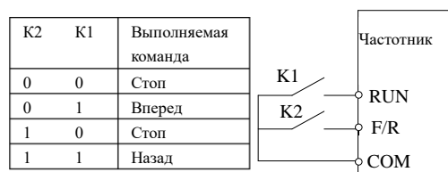
Рис. 6-14 Двухпроводной режим управления 2
